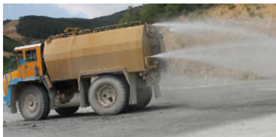
BAGNATURA VIABILITA' DI CANTIERE
